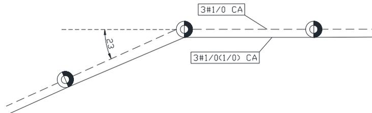
Figura 1 – Resultante de tração mecânica com dois esforços
