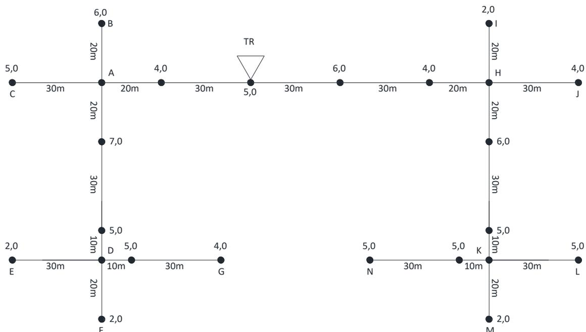
**Figura 3 – Modelo de cálculo de queda de tensão**
